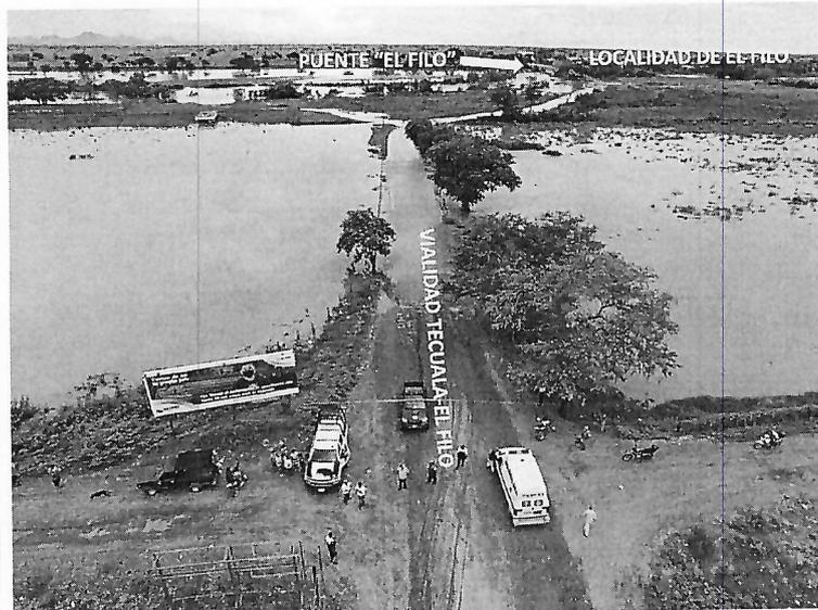
Debido a fenómenos meteorológicos atípicos y cambios en el cauce del río, la necesidad de adaptación es evidente. La longitud del puente actual ya no es adecuada para garantizar un flujo seguro del cuerpo de agua,
